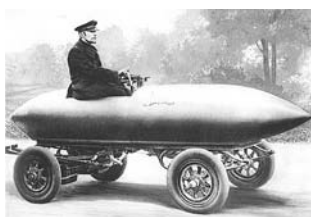
Virtaviivaisuutta on haettu lähinnä luodista? Kuvassa yli 100 km/h kulkenut 1899 Le Jamais Contente -sähköauto.
