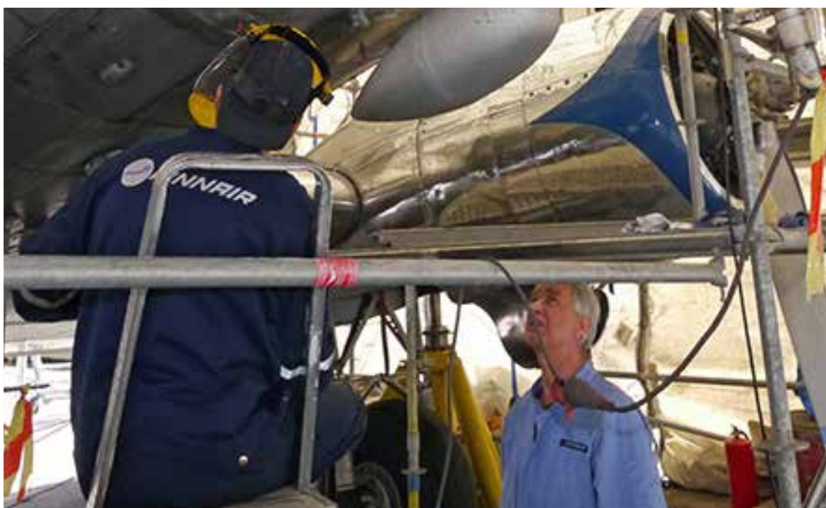
DC-3-lentokoneen alapinnan maalinpoisto käynnissä. Kuva: Reino Myllymäki.
