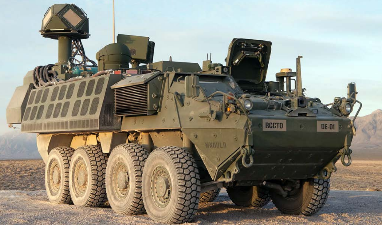
DE M-SHORAD -järjestelmä on Raytheonin valmistama laserasejärjestelmä.
