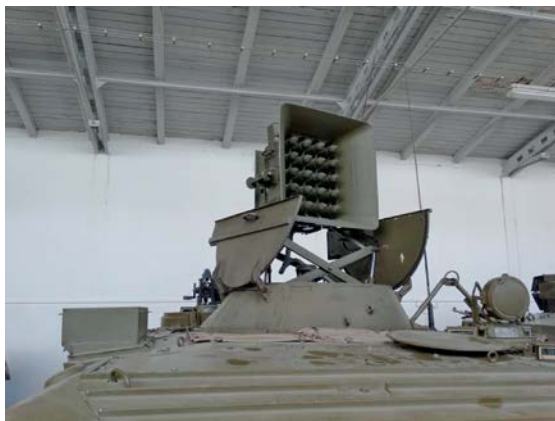
Tankin yhteydessä oleva kuulutuslaitteisto BÚRKA III. Järjestelmässä 3 kW:n äänitaajuinen tehovahvistin, jonka avulla viesti on saatu kuulumaan 8–9 km saakka.
