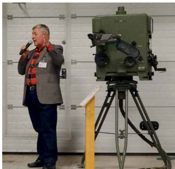
Yliluutnantti evp. Keijo Kari ja Delta-laskin. Laskimen yläosaan on modernisoinnissa lisätyt mm. Severi-tutkan vaatimat laitteet.
