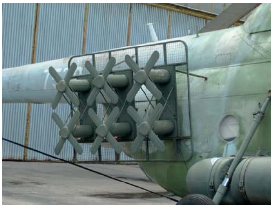
Tämä oli mielenkiintoinen. Kopterin molemmilla puolilla oli tuollaiset antenniryhmät. Esittelijän puheesta ymmärsin, että tuolla häirittiin USA:n lentokoneilla tehtyä tiedustelua.
