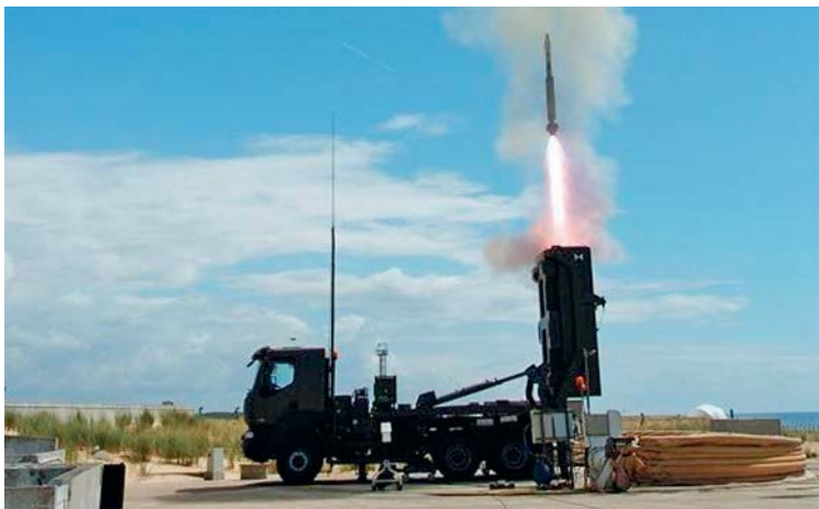
VL MICA -ohjuslavetti ja tutka (Kuvallähde: www.indiandefencereview.com , www.defencetalk.com.it ).
