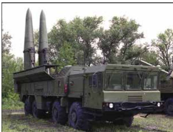
9M723 Iskander-M -ohjusjärjestelmän 9P78-laukaisujoneuvo.
