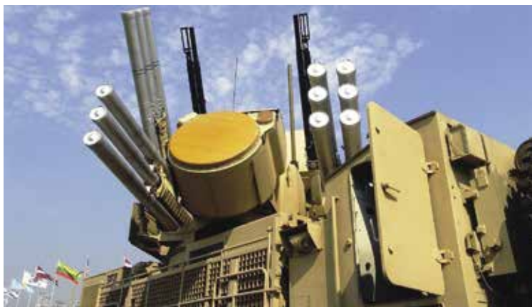
Pantsir-S1 järjestelmän tornin asejärjestelmät 2 kpl 30 mm kaksoiskannuunaa ja kaksi 3+3 ohjuksen erikseen korkeus suunnattavaa kasettia. (© CC BY-SA4.0, Vitali Kuzmin)
