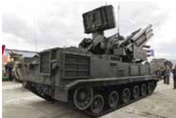
Pantsir-S1 järjestelmä asennettuna meillekin tuttuun GM-352 telalavettiin. (© Wikipedia, Vitali Kuzmin)
