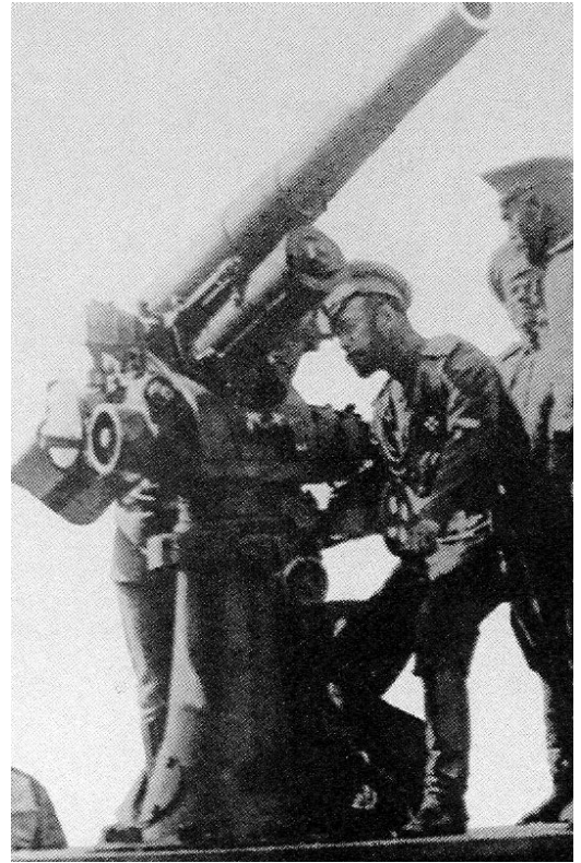
76 mm M/1914 Putilov oli Venäjän ensimmäinen ilmatorjuntatykki. Venäjän keisari Nikolai II tutustumassa tykin suuntaamiseen.
