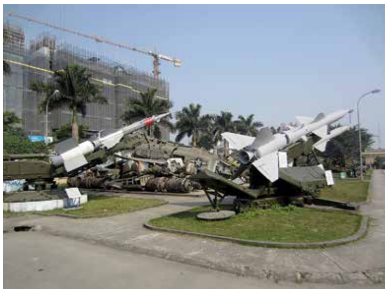
Venäläiset it-ohjukset S-75 (SA-2) oikealla ja S-125 (SA-3) ovat olleet käytössä monessa sodassa. Lavetit on kuvattu Hanoi ilmapuolustusmuseossa. (Kuva: A. Lappi)
