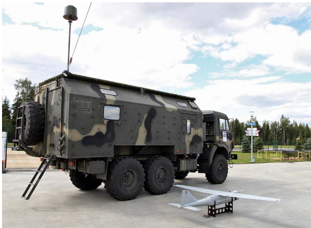
Venäläisten käyttämällä Leer-3-järjestelmällä voidaan yhteistyössä Orlan-10-droonin kanssa estää matkapuhelinten käyttö alueella.
