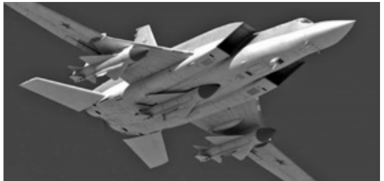
Tu-22M3-pommikone siivet hidaslentoasennossa varustettuna kolmella Kh-32-ohjuksella ( www.defencetalk.com ).
