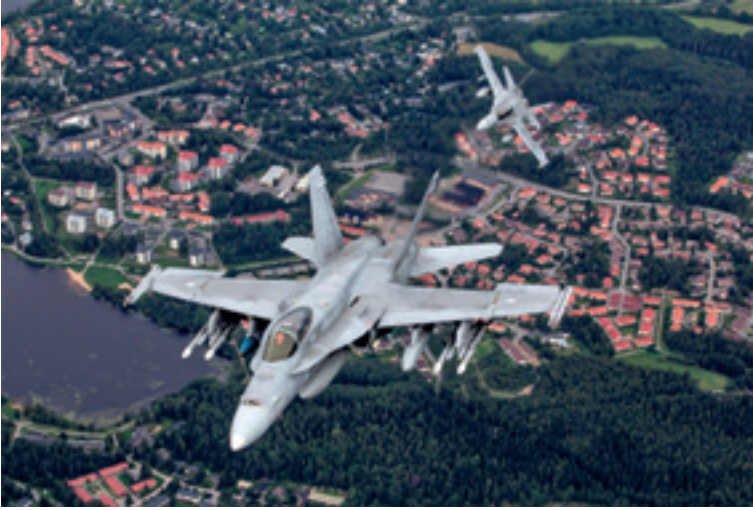
F/A-18-monitoimihävittäjä varustettuna Sidewinder 9X, AIM-120 AMRAAM ilmasta ilmaan -ohjuksilla, JDAM-täsmäpommilla ja JSOW-rynnäkköohjuksella.
