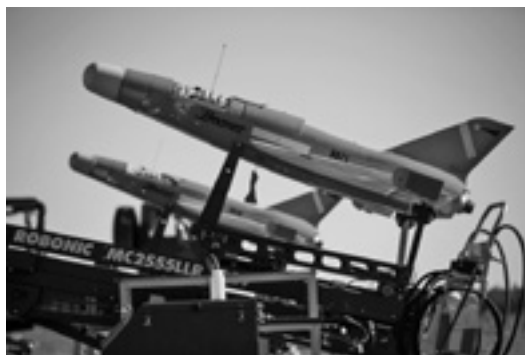
Uusin käytössä oleva maalilennokki (JET Banshee 40) suihkumoottorilla valmiina tehtävälle. Vastaava lennokki kahdella suihkumoottorilla saadaan käyttöön IPH117-harjoitukseen. (Kuva Puolustusvoimat)
