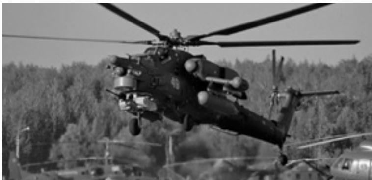
Mi-28NM-taisteluhelikopteri, 30 mm tykki ja nokan sensorivarustus hyvin esillä (Sputnik, Vitali Belousov)
