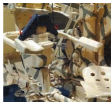
Boforsin 40 mm:n it-tykin eräs variaatio. Ampujan paikka, josta ohjataan tykkiä liikuttavia sähkömoottoreita. Tähtäimiä ei ollut esillä, mutta ilmeisesti ne olivat optiset. Ampujan lisäksi tykillä tarvitaan lataaja.
