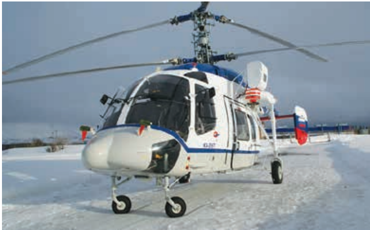
Ka-226, kuvassa erottuu hyvin vaihdettava tehtäväkontti. (© Venäjän Helikopterit Yhtymä)
