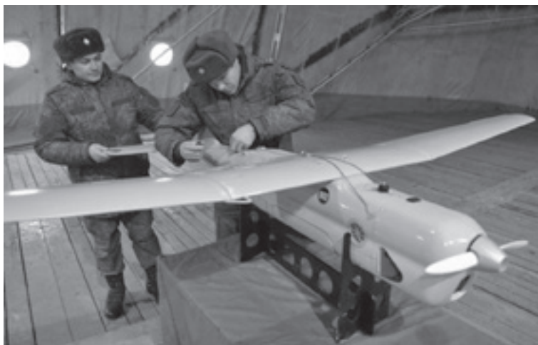
Orlan-10 on katapultilta (ei kuvassa) lähetettävä miehittämätön ilma-alus, joka on käytössä Venäjän asevoimissa (kuvalähde: http://www.rg.ru/2015/01/14/reg-kfo/bla.html ).
