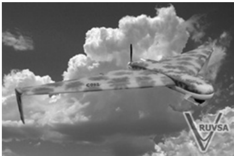
Eleron-10 miehittämätön ilma-alus (kuvalähde: http://ruvsa.com/catalog/eleron-10/ ).
