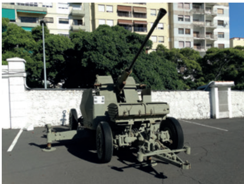
Boforsin 40 mm:n tykki oli muutettu tulenjohtolaitteen ohjaamaksi. Arvelin varajärjestelmänä säilytetyn käsisuuntauksen.
