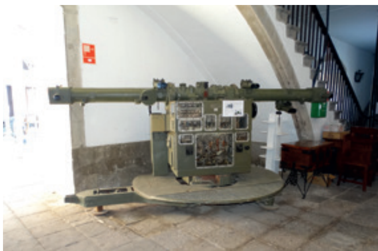
Tulenjohtokone oli aukaistu, joten laitteen mekaniikan pääsi näkemään. Vivuilla, muutokappaleilla, rattailla ja moottoreilla pystyttiin laskemaan ampuma-arvot tykeille.
