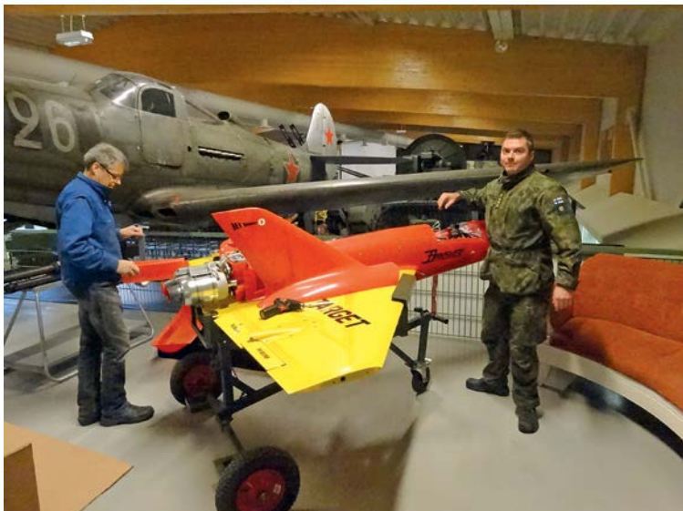
Aki Anttila (vas) ja Riku Niemenmaa kokoavat Banshee Jet 80 -maaillennokkia näyttelykuntoon. Lennokissa on kaksi 40 kiloa työntövoimaa kehittävää suihkumoottoria.
