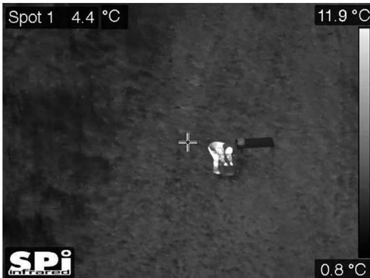
Yhdysvaltalaisen MD-1-lennokin lämpökamerakuva henkilöstä asentamassa miinaa. Kameran erottelukyvyn tarkkuus 0,4 celsiusastetta. Kuvassa maalämpö on 4,4 celsiusastetta (Kuvälähde: www.x20.org )
