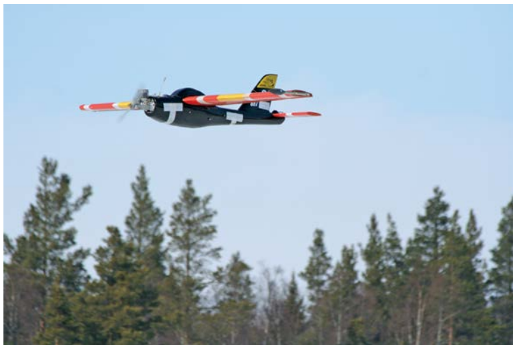
Avartekin AT 04 -maalilennokka, lennokin siiven kärjessä on Secapemin PL 153 osumailmaisain.
