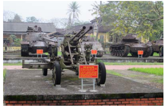
Pohjois-Vietnamilla oli tuhansia ilmatorjuntatykkejä. Kuvassa venäläinen 37 mm kaksoistykki, jonka konstruktio jäljittelee 40 mm Bofors-tykkiä.
