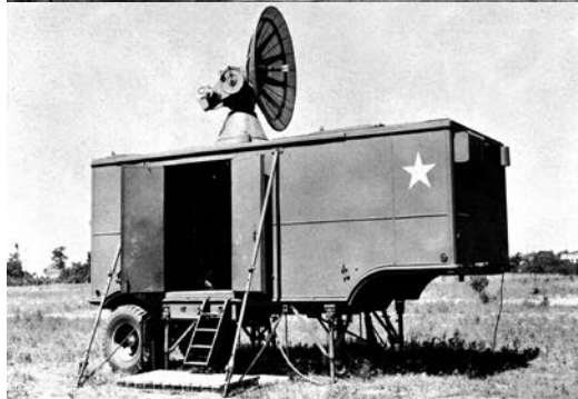
Amerikkalaisten 90 mm tykki heräteammuksi- neen, elektroninen M9-keskuslaskin ja moderni tulenjohtotutka SCR-584 oli tehokas asejärjes- telmä V1-kostoaseiden torjunnassa.
