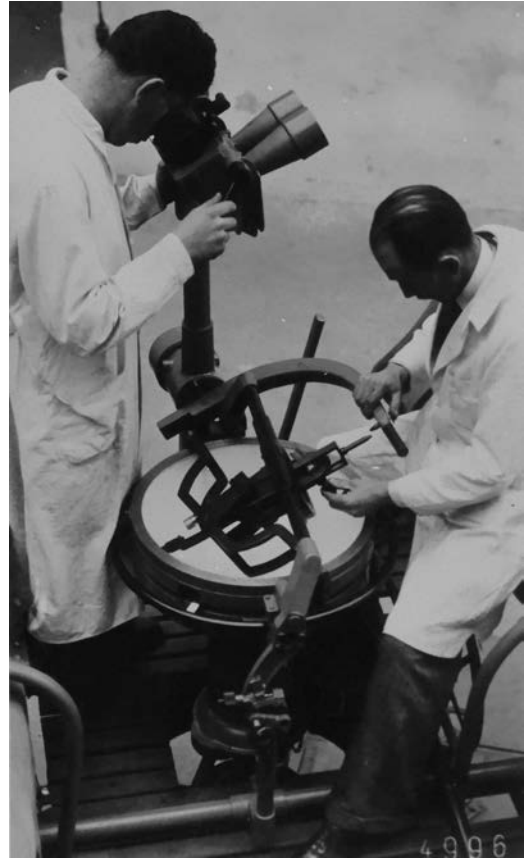
Goerz-kuulosuuntimen "laskin", jolla voitiin määrittellä lentokoneen oletettu paikka. Tähtystyskiikarit kääntyivät oletettuun paikkaan.
