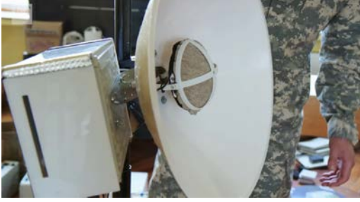
Zvook-järjestelmän akustinen kuunteluasema. Järjestelmä havaitsee akustisesti matala- ja keskikorkeuksilla lentävät risteilyohjukset, helikopterit, dronet ja hävittäjät.
