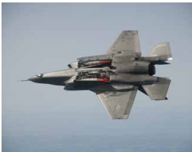
F-35:n asekuorma kuljetetaan normaalisti sisäisissä asekuiluissa. Kuva: Lockheed Martin.
