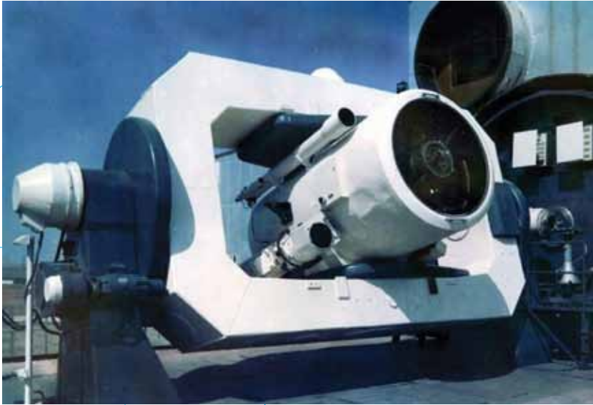
Laser-asetta "Terra-3" suunniteltiin vuosina 1966–1978. Kuussa järjestelmän lasertutkan teleskooppi. Kuva: Wikipedia.
