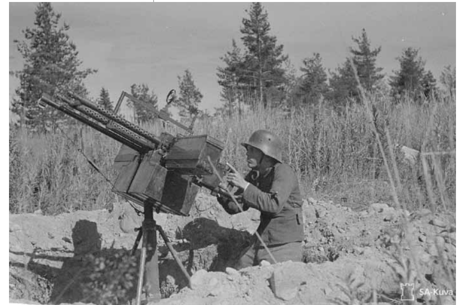
Kotimainen kevyt kaksoisilmatorjuntakonekivääri 7,62 ItKk/31-40 VKT. Kuva: SA-kuva.
