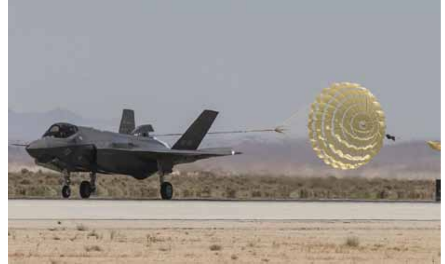
F-35A jarruvarjotestissä Edwardsin tukikohdassa Kaliforniassa. Myös Suomen F-35-koneet varustetaan jarruvarjoilla suomalaisten talviolosuhteiden vuoksi. Kuva: Lockheed Martin.
