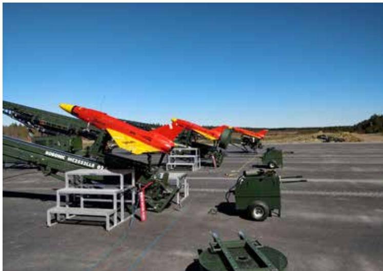
Bansheet laukaistaan taivaalle kotimaisilla paineilmakatapulteilla (Kuva: Puolustusvoimat)
