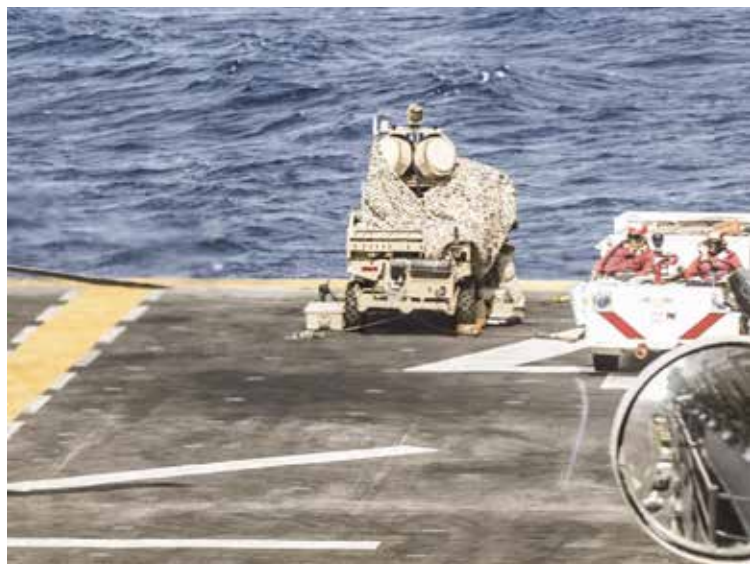
Iranilaisen lennokin pudottanut LMADIS-järjestelmä USS Boxer -maihinnousualuksen kannella. Kuvalähde: https://www.thedrive.com/the-war-zone/29063/marine-anti-drone-buggies-on-uss-boxer-knocked-down-threatening-iranian-drone
