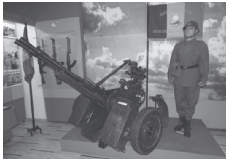
Romaniassa valmistettu ilmatorjuntatykki vuodelta 1974, kaliiperi 14,5 mm. Rakennratkaisut kuin tutussa Sergeissä.
