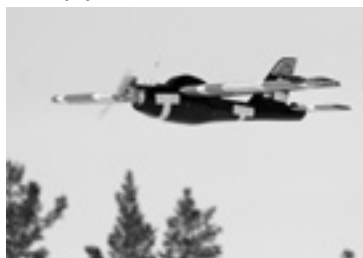
Avartekin AT 04 maalilennokki, lennokin siiven kärjessä on Secapemin PL 153 osumailmaisain.
