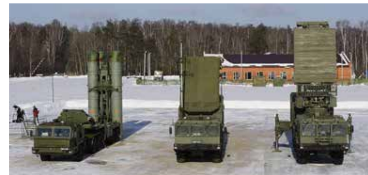
5P85SM ohjuslavetti, 92N6 tulenjohtotutka ja 96L6 valvontatutka (Kuvälähde: http://www.radartutorial.eu/19.kartei/06.missile/karte006.en.html )
