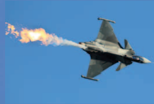
SAAB Gripen E. Konetyypin koelento-ohjelma on vielä kesken. Se oli nyt ensi kertaa esillä suomalaiselle yleisölle. Kuva on otettu näytöstempun aikana, jolloin polttoainetankin huohotinputkesta tuleva polttoaine syttyy jälkipolttimen liekistä.
