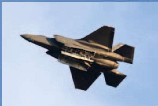
F-35 luukut auki. Koneen stealth-ominaisuuksiin kuuluu asekuorman kantaminen rungon sisäisesti, etteivät ne aiheuta tutkapoikkipinta-alan kasvua.
