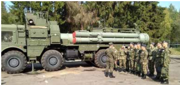
S-400 ilmatorjuntaohjuslavetti 9M96 ohjuskasetilla ladattuna.
