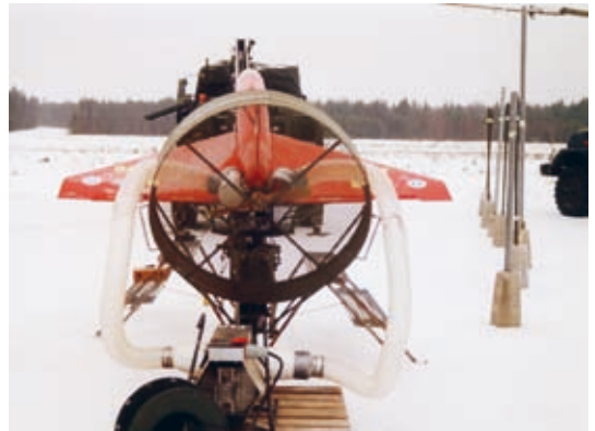
Bansheen käyttö- ja huoltokoulutus järjestettiin Lohtajalla helmikuussa 2005, jolloin oli normaalit talviajan pakkaset. Moottori oli tyyppinä aivan uusi ja valmistajan kouluttajillakaan ei ollut siitä kokemusta. Moottorin lämmittämiseksi kehitettiin paikan päällä "Hellfireksi" nimetty moottorinlämmitin. (Kuva: Mikko Mäkinen)
