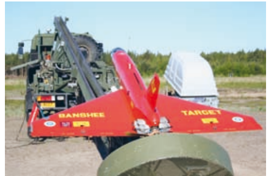
Banshee 500 -maalilennokkia käytettiin ohjusammuntojen maalilaitteena. (Kuva: Mikko Mäkinen)
