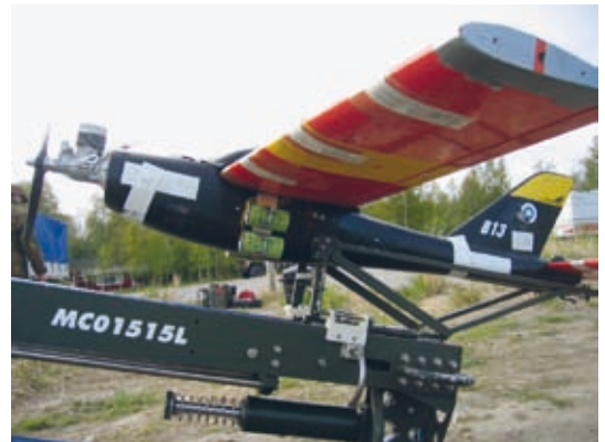
AT 04 -maalilennokki valmiina lentoonlähtöön ensimmäisissä ITO05 -ammunnoissa Lohtajalla 2. kesäkuuta 2006. Kone on varusteltu laserheijastinteipeillä ja visuaalista näkyvyyttä parantavilla merkisavuilla. (Kuva: Mikko Mäkinen)
