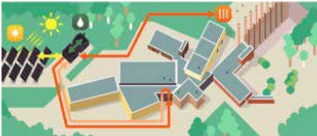
Sakarinmäen koulukeskuksen lämmitysratkaisun muodostavat maalämpö, aurinkolämpö, lämpökeskus ja lämmön varastointi maaperään.
