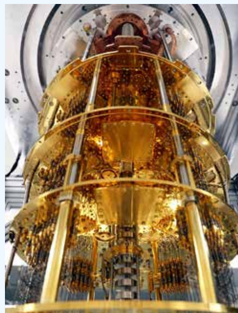
VTT:n 50 kubitin kvanttietokone kuvattuna rakentamiskuvassa. Kuvallähde: VTT
