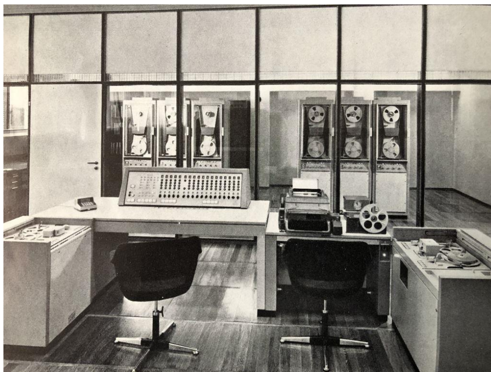
KOP:n Siemens 2002:n ohjauspöytä, taustalla lasiseinän suojaamana pöly- ja lämpöeristetyt magneettinauha-asetat
