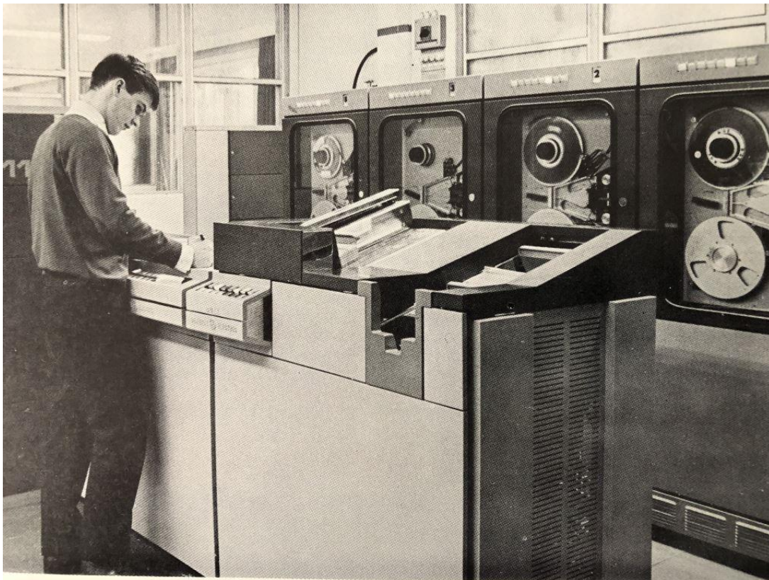
"Laskentakeskukseemme sijoitetun Apu-lehden GE-115 tietokoneen laitteistoa: edessä kortinlukija ja ohjauspöytä, takana neljä magneettinauha-asemaa"
