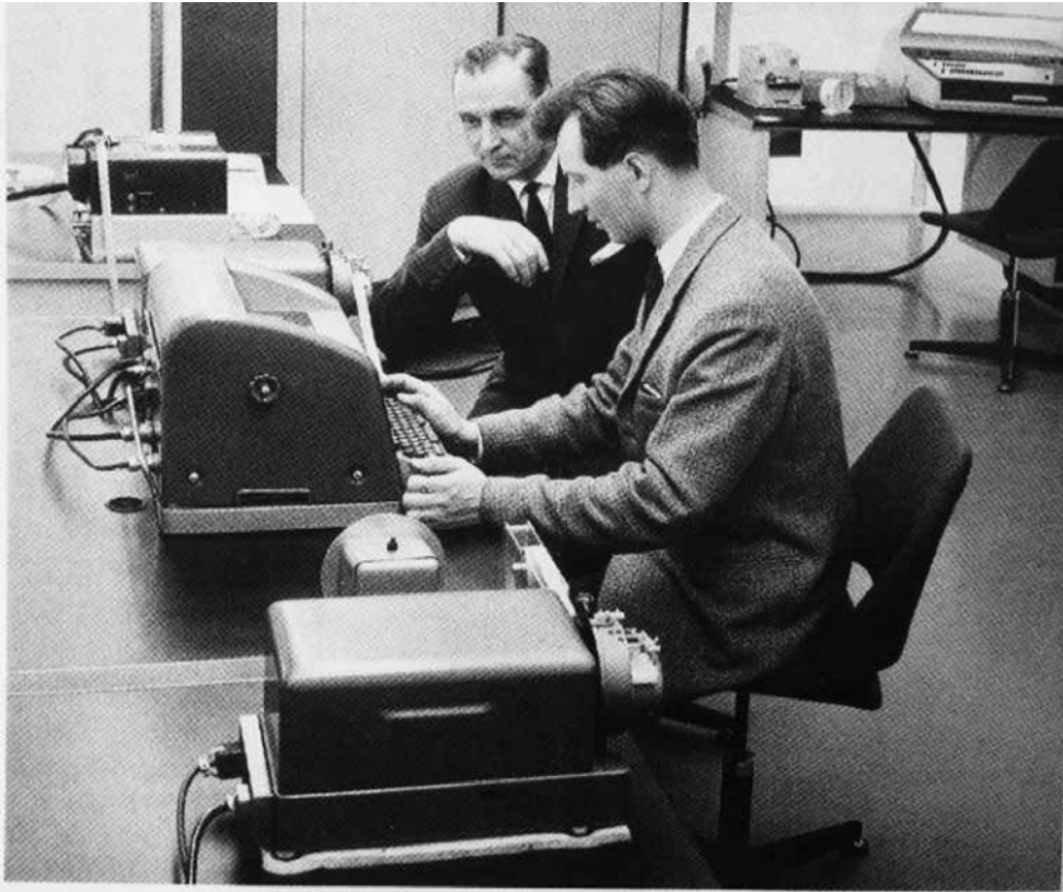
Kaapelitehtaan ensimmäinen Elliott 803 Salmisaaren tehtaalla vuonna 1960. Teleprinterin ääressä dipl.ins. Matti Jääskeläinen, hänestä vasemmalle dipl.ins. Lauri Saari. Laitteet edestä taaksepäin ja oikealle: teleprinterin mekaaninen rauhanlukija, reikänauhojen puolauslaite, Creed-teleprinteri, keskusyksikkö Elliott 803, optinen Elliott-reikänauhanlukija, ohjauspöytä. (Valokuva: ICL Data Oy:n arkisto)
