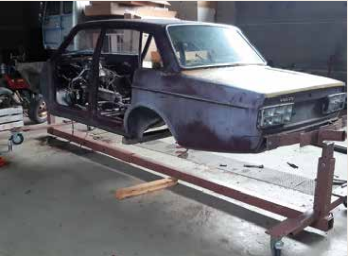
Auton aihio kiinnitettiin grilliin, jossa sitä oli erittäin miellyttävä työstää. Korissa on vielä 264:n takapaneeli takavaloiheen. Kuva 164:n entisointikertomuksesta
