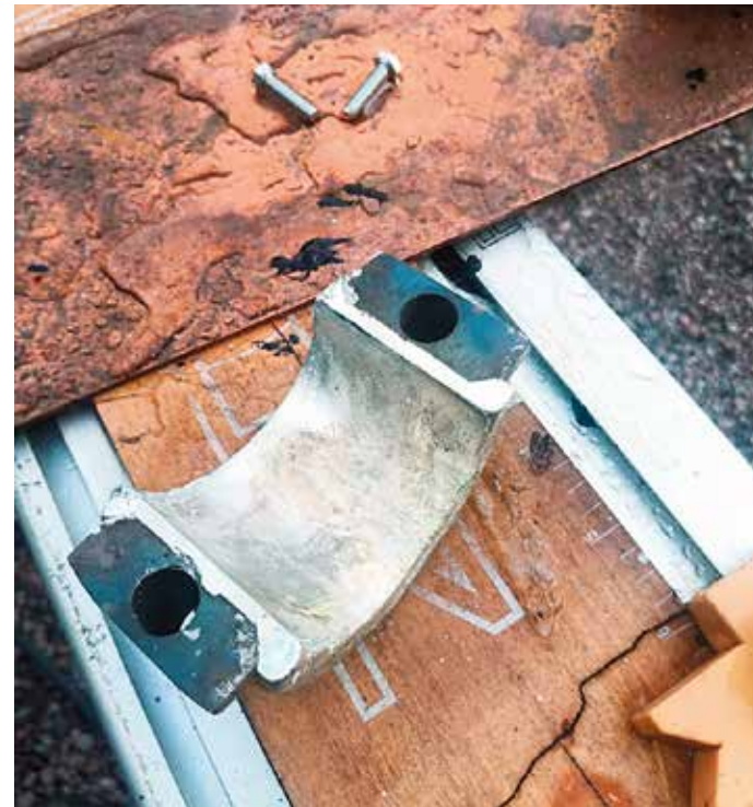
Onnistunut valu on yhtenäinen ja vapaa huokosista.
