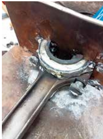
Sula laakerimetalli on kaadettu muotteihin, metallia kannattaa kaataa hivenen yli tarpeen, ettei pintaan muodostuva kuona pilaa laakeria.
