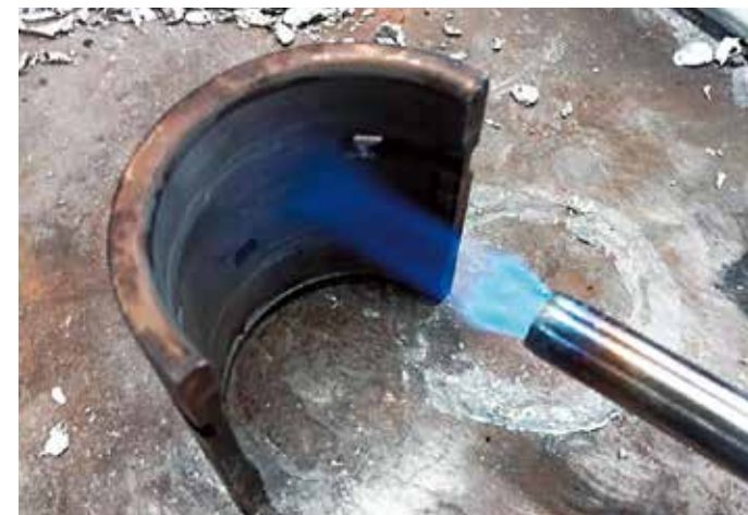
Vanha laakerimetalli poistetaan sulattamalla.
