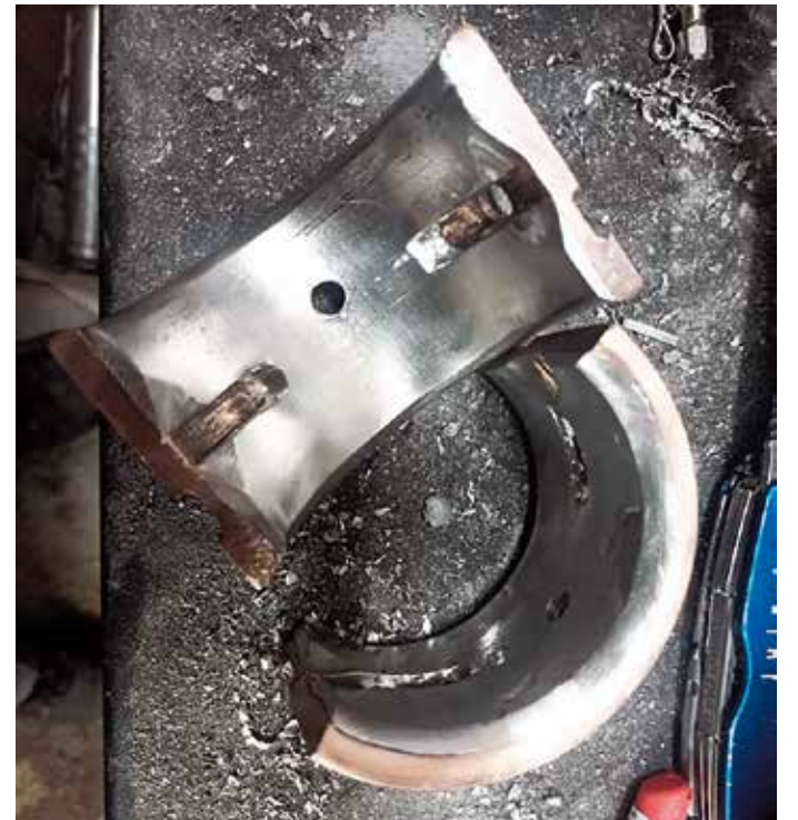
Runkolaakeri öljyreikineen ja urineen valmiina koneistettavaksi.
