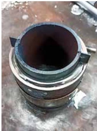
Sula laakerimetalli on kaadettu muotteihin, metallia kannattaa kaataa hivenen yli tarpeen, ettei pintaan muodostuva kuona pilaa laakeria.
