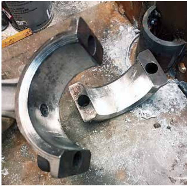
Pohjustus on koko valun kannalta tärkeä vaihe. Koko valettavan alueen pitää olla hyvin pohjustettuna, se vaikuttaa suoraan laakerimetallin kiinnittymiseen.
