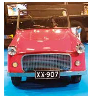
Mobilisti-lehden osastolla on aina ihmeveikeitä. Tämä ”oma valmiste” on rakennettu Vaajakoskella ja tyypikatsastettu ja rekisteröity vuonna 1963. Nykyiselle omistajalle se on siirtynyt vuonna 1977 ja entisöity ja museokatsastettu viime vuonna. Auton rakenne on perinteinen: moottori edessä, kardaani ja veto takana. Tekniikka perustuu vm. 53 BMW R35:n moottoriin ja vaihteistoon. Moottorissa on tietysti poljinkäynnistin. Auton voimalinjassa on Mossen laatiikko, joten välityssuhteita on neljä taaksepäin ja 12 eteenpäin. Kuva mpz
