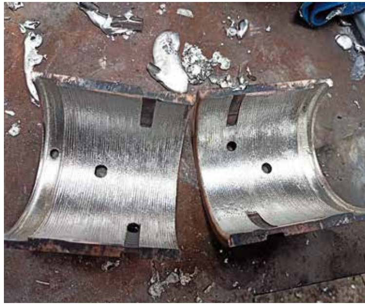
Pohjustus on koko valun kannalta tärkeä vaihe. Koko valettavan alueen pitää olla hyvin pohjustettuna, se vaikuttaa suoraan laakerimetallin kiinnittymiseen.
