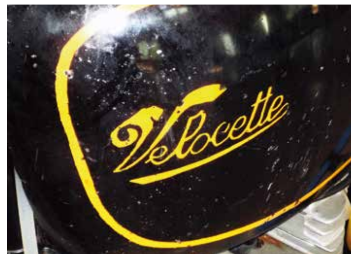
Englantilaiset tehdaskilpapyörät olivat käsiteollisia tuotteita. Sarjat olivat pieniä, joten raidoitukset maalattiin käsivaralla.
