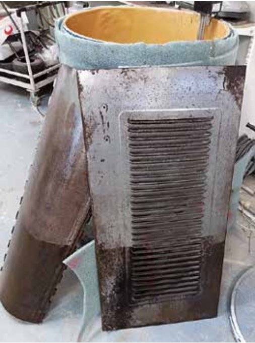
Osat olleet puoliksi lipeäkylvyssä noin 24h.
