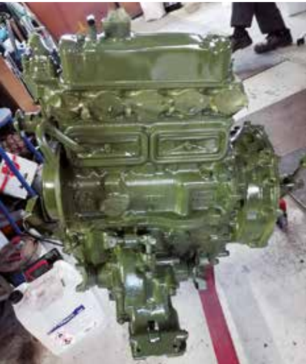
Peruskorjattu Minin 850 moottori. Kuva Seppo Peräinen
