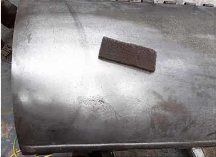
Pintaan muodostunut kerros lähtee helposti esimerkiksi karhunkielellä.
