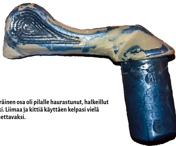
Hopeointi on tässä mallisarjassa ja vuosimallissa alkuperäinen pinnoitusmenetelmä.
