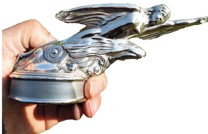
Hopeointi on tässä mallisarjassa ja vuosimallissa alkuperäinen pinnoitusmenetelmä.
