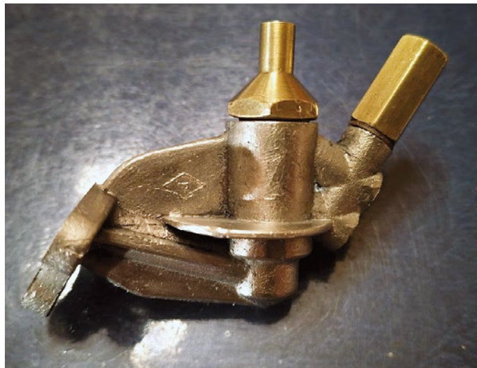
Suutinrunko valmiina, alkuperäiset suuttimet ja tulpat asennettuna.
