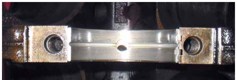
Öljykanavan reikä sivussa
