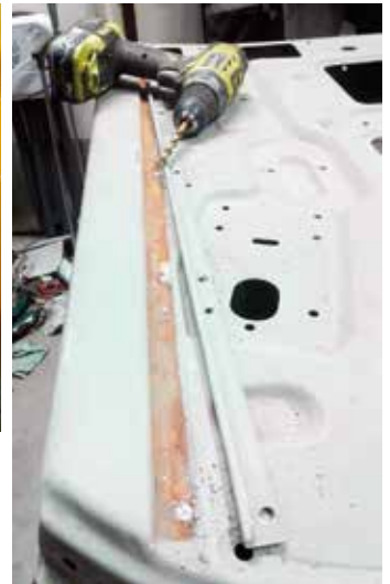
Suhteellisen tarkkaa puuhaa, että menee juuri samaan kohtaan, kuin aikaisempi, ettei osu oven kaari koriin sitten käytössä.
