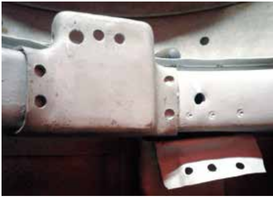
Korjattu korvake, poikittaisen kotelopalkin laipan taivutus ja hitsaus vielä, niin se on siinä. Sama toiselle puolelle.
