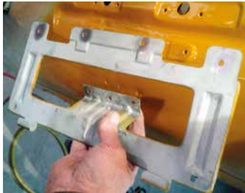
Rekisterikilven teline. Pitihän sekin tehdä, vaikka nykyisiä kilpiä siihen ei kiinni saakaan. Maalia piti laittaa takapintaan, kun ruisku ei enää taivu taakse, kun se on hitsattuna kiinni. Hitsauskohdista poistin maalin.
