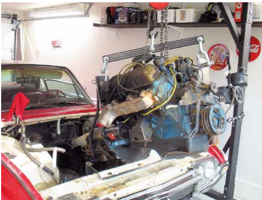
Moottori ja vaihdelaatikko, noin 380 kg paketti
