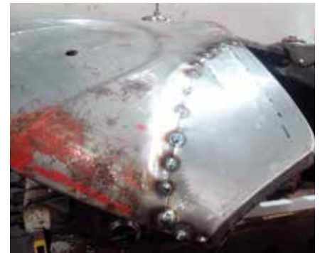
Lokasuojan etuosassa se alanurkkakin on ruosteella herkkä kohta.
