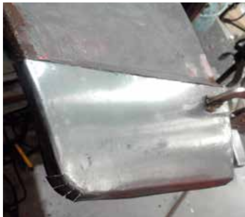
Suhteellisen tarkkaa puuhaa, että menee juuri samaan kohtaan, kuin aikaisempi, ettei osu oven kaari koriin sitten käytössä.
