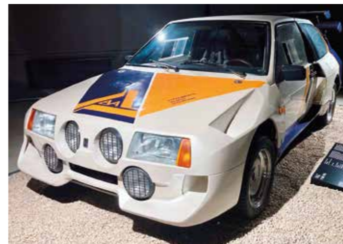
VAZ 2108 EVA. Liettualainen valmistuspaja muunsi 3 kpl näitä autoja keskimoottorisiksi ja vaihtoi korin osia lasikuituisiksi keventääkseen autoa ryhmä B ralliautoksi. Ryhmä B:ssä tapahtuneiden pahojen onnettomuuksien takia luokkaa varten ei enää tarvinnut rakentaa autoja ja EVA jäi "kananlennoksi". Tehoa muutosten jälkeen moottorista sai jopa 300 hp ja huippunopeutta 200 km/h.
