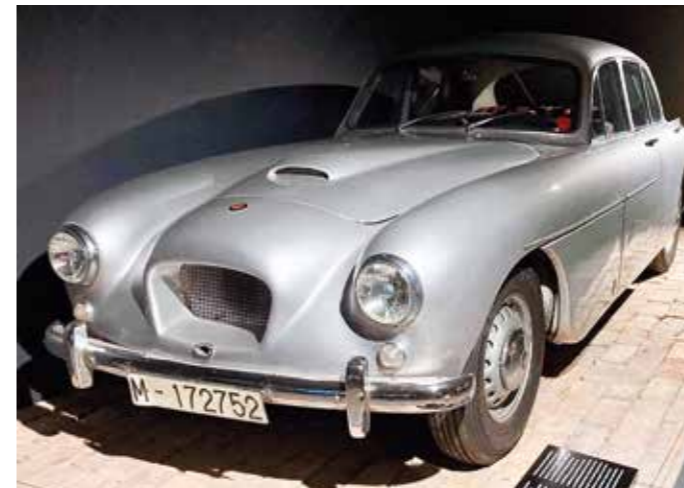
Bristol 405. Englantilainen lentokonevalmistaja the Bristol Aeroplane Company mietti II maailmansodan jälkeen tuotantoonsa vaihtoehtoista liiketoimintaa. Yritys uudisti Eisenachin tehtaan BMW:n piirustuksia, etenkin korin osalta. Syntyi Bristol 405, jota valmistettiin vuosina 1953-1958 yhteensä 308 kpl. Tehoa autolla oli 125 hp ja huippunopeutta 169 km/h. (Saman tyyppinen tarina kuin Moskvitch'illa, jota sentään Neuvostoliitossa valmistettiin Opel Kadetin piirustuksia muokaten tuhansittain.)
