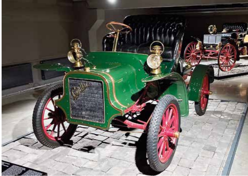
Cadillac Model K Runabout. Valmistettu USA:ssa 3650 kpl vuosina 1906-1908. Moottorin teho 9 hp ja huippunopeus 55 km/h. Alkuvaiheessa auto oli rikkaiden "leikkikalua" ja vaurauden symboli. Se oli kuitenkin myös osaltaan tiennäyttäjää urbaaneille ajoneuvoille, kuten Ford T-malli.
