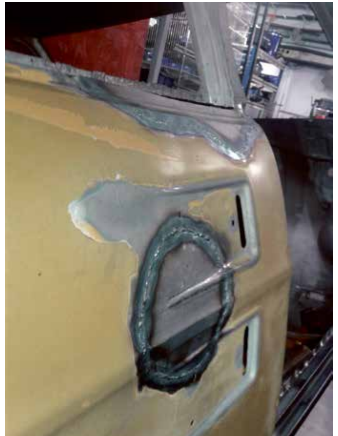
Teipillä tehty vauriokohdan rajaus. Teippikuvion mukaan tehdään uusi pala ja vauriokohta irrotetaan teippirajauksen mukaisesti.
