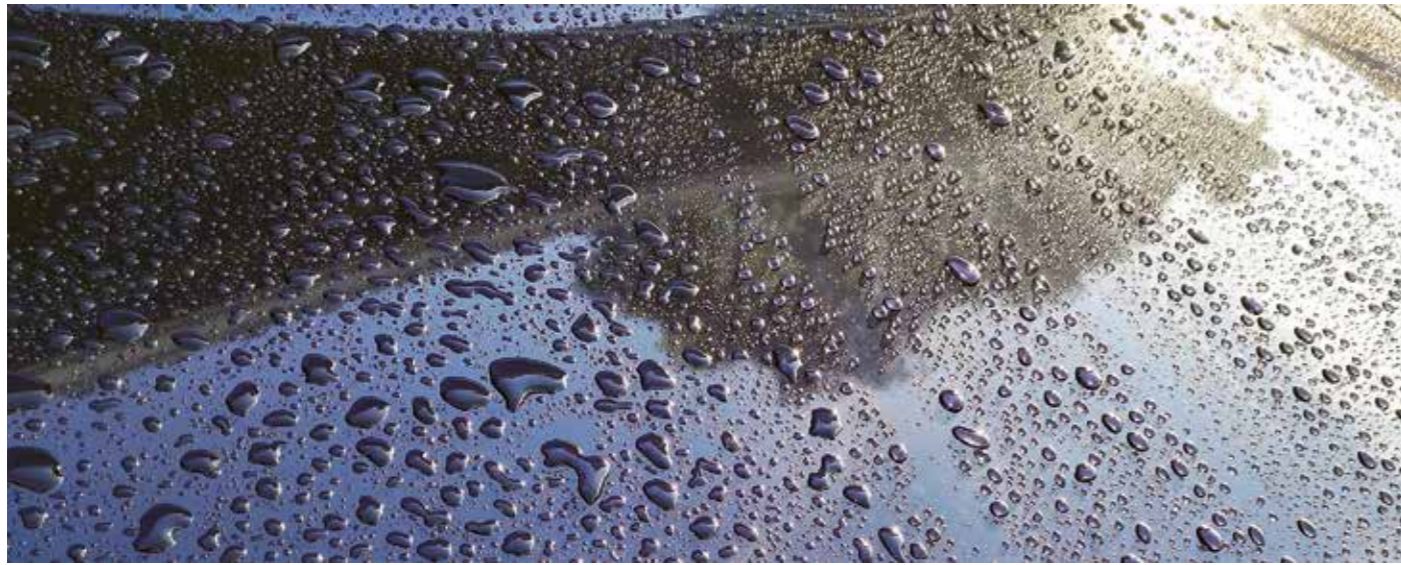
Useiden pesujen jälkeen: Vasemmalla tavallista vahaa ja oikealla uutta teknologiaa. Hyvin näkee, miten helmeily oikealla puolella pyöreämpää.
