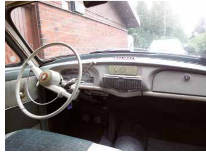
Frégate on tähdätty 1950-luvun Euroopassa paremman keskiluokan autoksi. Renault on tulkinut sen tarkoittavan kuuden hengen autoa, joten autossa on sohvapenkki edessäkin. Ranskalaiseen tapaan rattiakselissa oli viikset molempiin suuntiin eli vasen valoille ja oikea vilkuille sekä vaihteen valitsin. Auto on sisältäkin vaalean tyylikäs, kuten ulkomuotokin.
