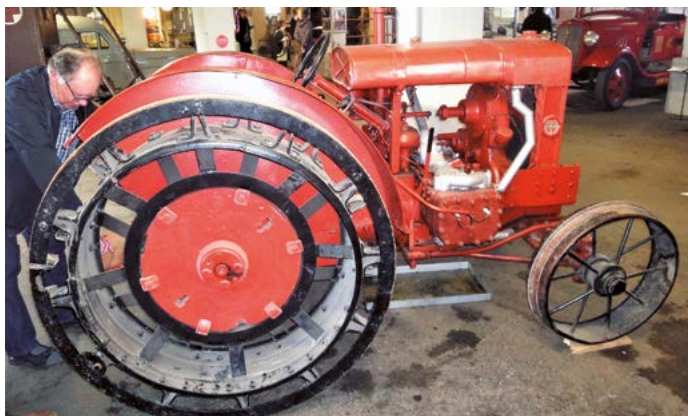
Aiemmin mainittu Oy Haldin Ab valmisti vuosina 1947-1948 pienen sarja, 12 kappaletta Vaasa-traktoria. Petroolikäyttöinen bokser-moottori ja rautapyörät olivat jo kovasti vanhanaikaiset verrattuna muuhun tarjontaan. Vaasa-traktoreita on kuvan härvelin lisäksi säilynyt toinen kappale. Vaasan Automuseo pitää hienosti yllä Vaasan teollista perinnettä, mistä Wärtsilän laivamoottorit tällä hetkellä ovat maailman huipputuote.
