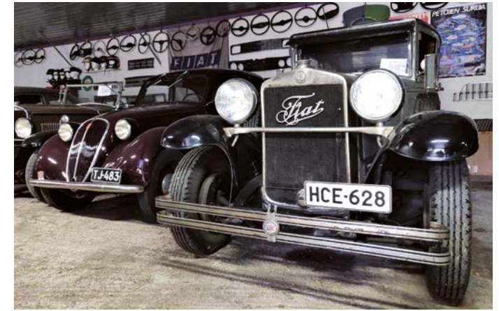
Fiat 525 Limousinen keula on tallin komeimpia. Suurta autossa on myös kulutus, noin 24 litraa bensiiniä sadalla kilometrillä.
