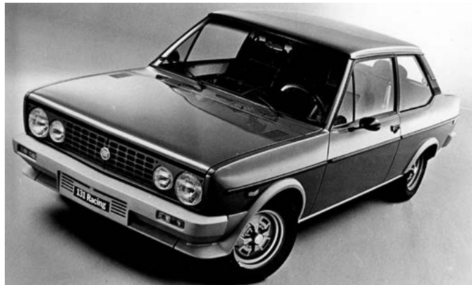
Fiat 131 Racing, 2000 cc twincam, 115 din hv, 180 km/t
