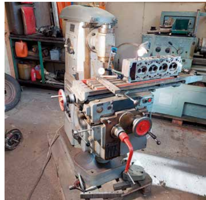
Kalkun verstaas oli Ilmari Fastin ja virolaisen yhtiökumppanin Epron yrityksen Epro-Fast Oy:n entinen varasto. Yritys oli tuonut neuvostoliittolaisia sorveja ja jyrsimiä. Näitä varastoon jääneitä sai tiettyä hyödyntää ja tässä jyrsitään Saabin alumiinikantaa vuoden -68 neuvostoliittolaisvalmistisella jyrsimellä. Hyvin toimi, mutta koska terä oli liian kapea, kanteen jäi noin yhden satkun korkuinen jälki. Tämän vielä moottorikoneistamo Häihälä plaanasi, kun lohko ja muutkin osat meni hoonaukseen, laakerikaulojen kiillotukseen ja venttiilin istukoiden koneistukseen. Kuva Pyryn kotiarhivista
