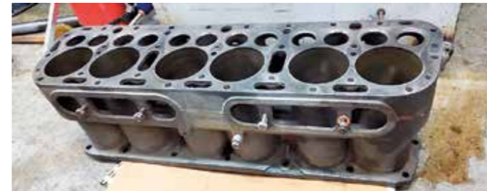
Sylinteriryhmä StripAll-käsittelyn jälkeen, tästä on hyvä jatkaa.
