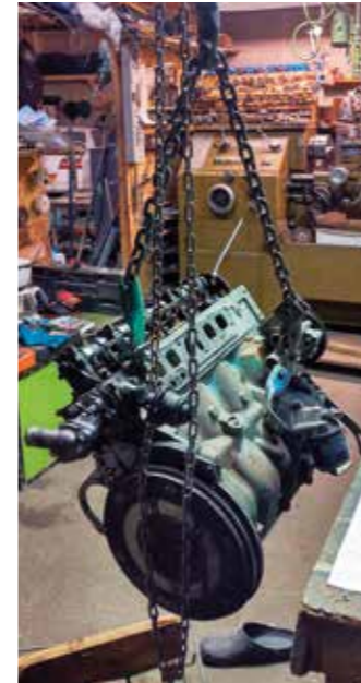
Tässä projektikuvaa ensiautoni kunnostuksesta; irroitettu moottori roikkuu taljassa Sileesuonkadun elementtivalimossa. Kuva Pyryn kotiarhivista
