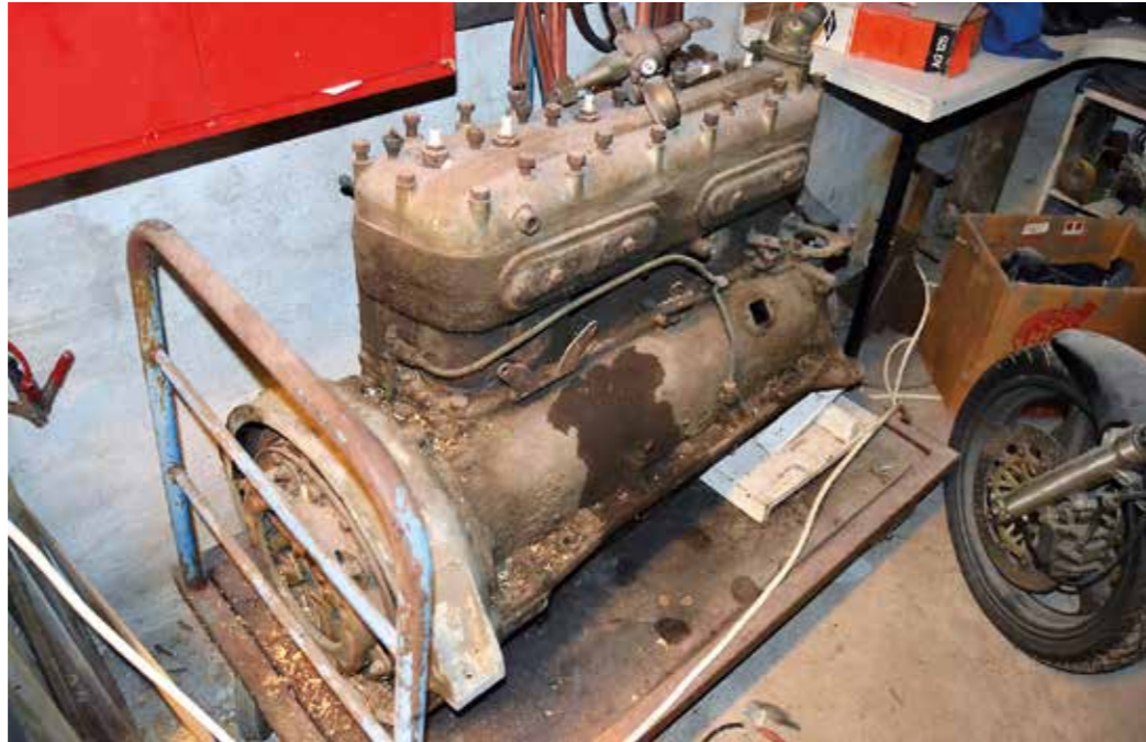
Autoon vaihdettu Studebaker Commanderin moottori on valmistettu loppuvuodesta 1927 ja eroaa hieman alkuperäisestä mm. kampiakselin ja öljypohjan osalta.
