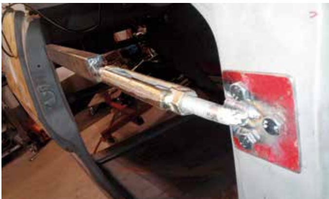
Vanttiruuvi takalokasuojan ja A-pilarin välissä
