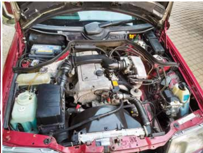
M111 2.2 litrainen ja 16 venttiilinen 150hv voimanpesä
