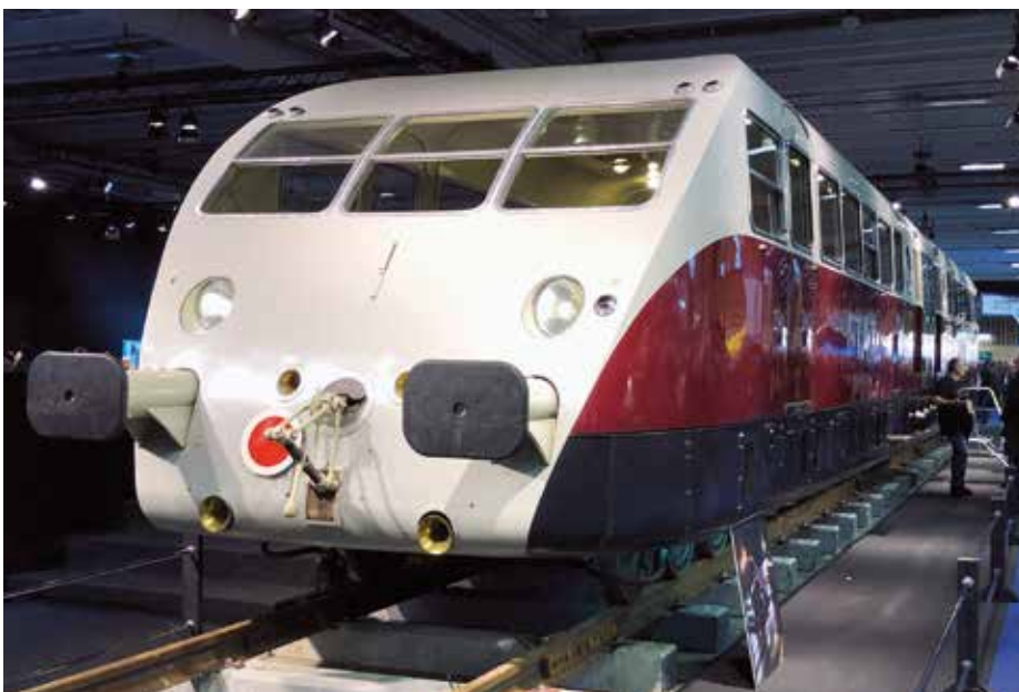
Ettore Bugattin kaikki tietävät 20- ja 30-lukujen kilpa-autojen ja loistoautojen valmistajana. Mutta Bugatti valmisti v. 1933 myös Ranskan nopeimman pikajunan. Neljä Bugatti Royale auton V8 moottoria yhteen, 51 l / 800 hv. Matkustajia 50 -100 henk. Nopeusennätys 192 km/h!
