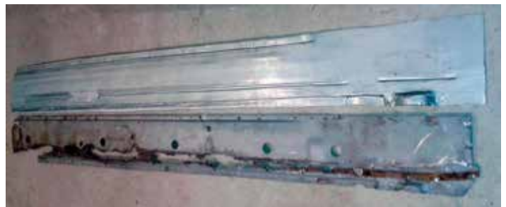
Uusi helmapelti, jonka tein suorasta pellistä. Alla alkuperäinen pelti
