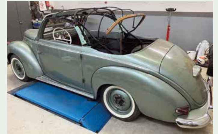
Kattokehikko kunnostettuna odottaa uutta kangaskattoa.
