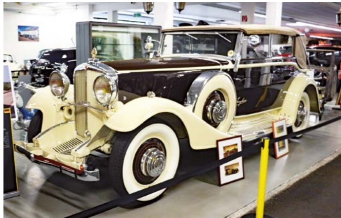
Maybach DS 8 Zeppelin vuodelta 1932. 12-syl, V12, 200 hv, 8000 ccm, 160 km/h, 3300 kg. Kori Spohn, Maailmanlaajuisesti yksilöitä on olemassa 25.
