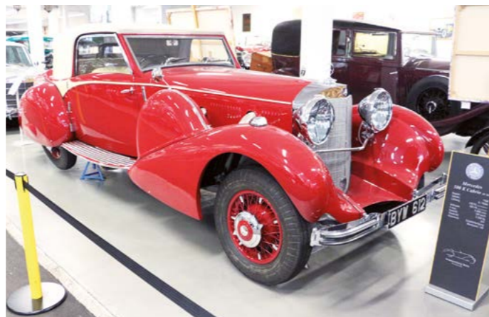
Mercedes-Benz 500 K Cabrio (W29) vuodelta 1935, 8-syl rivi, 100 hv ilman kompressoria ja 160 sen kanssa, 5000 ccm, 160 km/h, 2300 kg, valmistettu 354 yksilöä.
