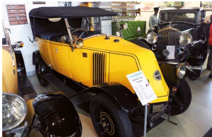
Renault NN Torpero, vm 1924, 4 syl rivi, 951 ccm, 17 hv, nopeus max 56 km/h, 3-vaihdetta. Ranska.
