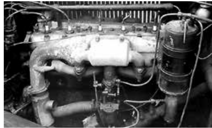
Moottori oli vaihtunut 1927 Commanderin moottoriin, joka oli pieniä yksityiskohtia lukuun ottamatta samanlainen kuin alkuperäinen. Jostain syytä sylinterikansi sekä kaasutin olivat auton alkuperäiset.
