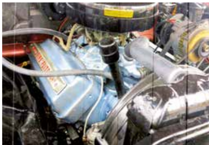
DeSoton koneestakin tuli hieno, kun se piti purkaa ja koota uudelleen. Se on alkuperäistä parempi, kun sähköjärjestelmä piti muuttaa 12 voltiseksi, jotta startti jaksaa pyörittää moottorin käyntiin.
