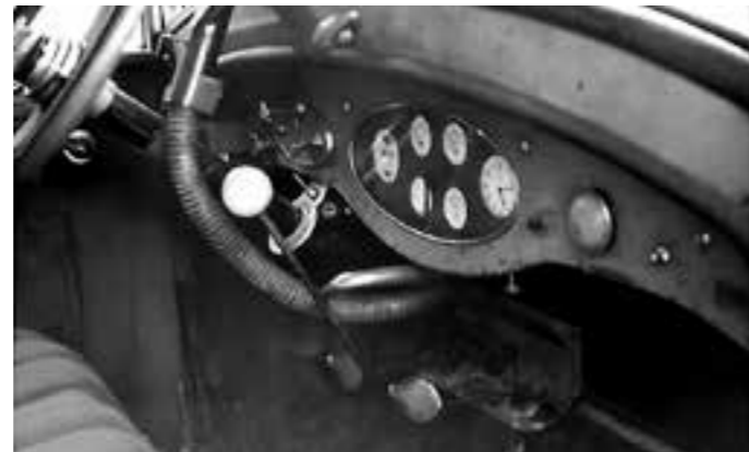
Auton ohjaamossakin oli kaikki paikoillaan, jopa oikeassa laidassa näkyvä ulosvedettävä työvalo, joka piilottaa taakseen noin neljän metrin itsekelautuvan sähköjohdon. Kuvassa näkyy myös ajalleen tyypillinen tuulilasin huurteenpoistusuutin.
