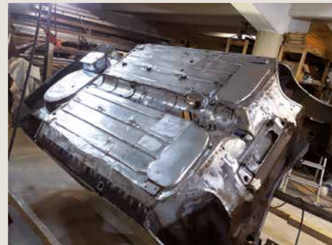
Uutta peltiä on pitänyt sovittaa paljon. Ei ihme, jos usko oli koetuksella. Kuva Pasi Myllymäki
