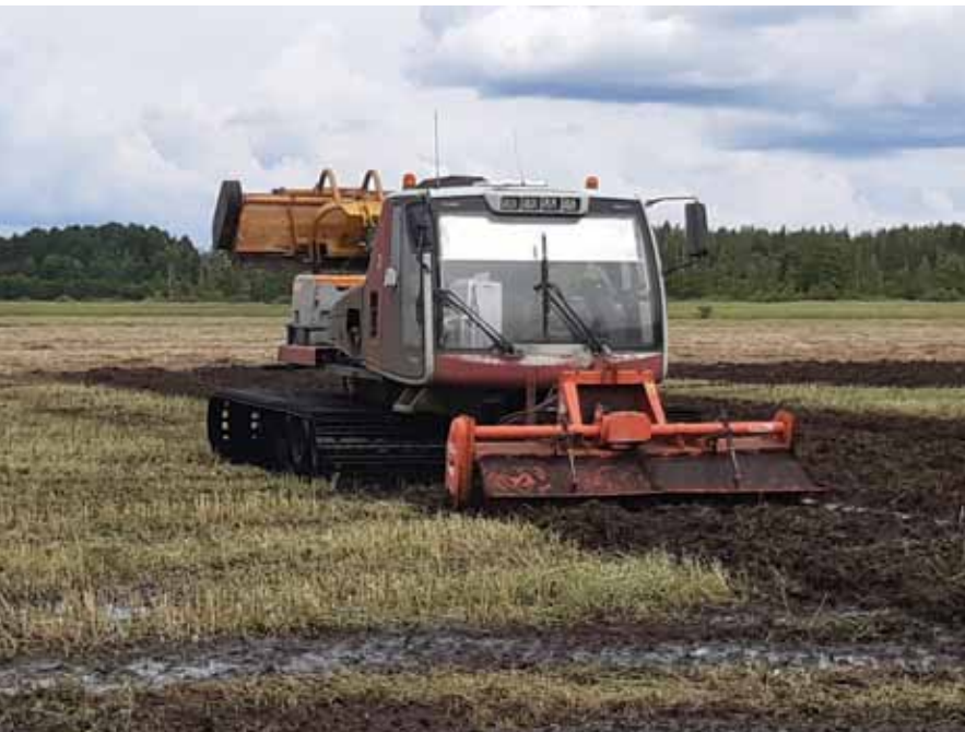
Järviruo'on juurakon jysintää Virolahden Kirkonturalla. Pehmeiden rantaluhtien niitto vaatii tela-alustaista erikoiskalastusta, jota on Suomessa vain harvalla yrittäjällä. Samoilla rinnekoneilla voidaan operoida niittomurskainta ja jysintää. Jysintä on vielä niittoakin tehokkaampi järviruo'on taltuttaja, ja jysinnällä voidaan luoda kahlaajien ja sorsien kannalta tärkeää ruokailuympäristöä. Kuva: Veli-Matti Sorvari
