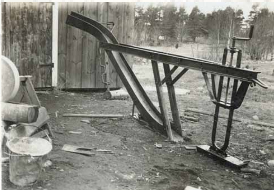
Täckdikningsplogen konstruerad av ingenjör Carl Carlsson på Storpetas. Carl Carlsson arbetade vid Maskin och Bro.
