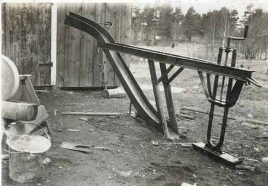
Salaoja-auran oli rakentanut insinööri Carl Carlsson Storpetaksesta. Hän työskenteli Maskin och Bro -nimisessä yrityksessä.
