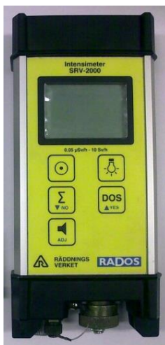
Kuva 22. SRV-2000 –mittari. Käyttöliittymän symbolit yhteneväisiä RNI-10 –mittareihin, etulevytarran väri SRV-keltainen. (Kuva: Mirion Technologies (RADOS) Oy).
