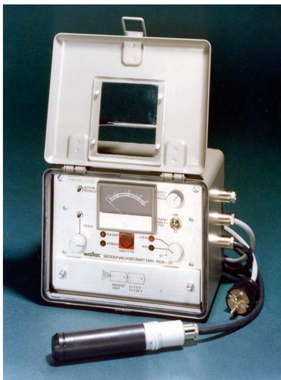
Kuva 10. RDA-31 –valvontamittari alkuperäisessä kotelossaan. Ilmaisimien on sama kuin RD-9 –mittarissa, aluksi se oli PA-muovikotelossa, mutta myöhemmin kotelomateriaaliksi tuli eloksoitu alumiini häiriönsiedon parantamiseksi (Kuva: Mirion Technologies (RADOS) Oy).
