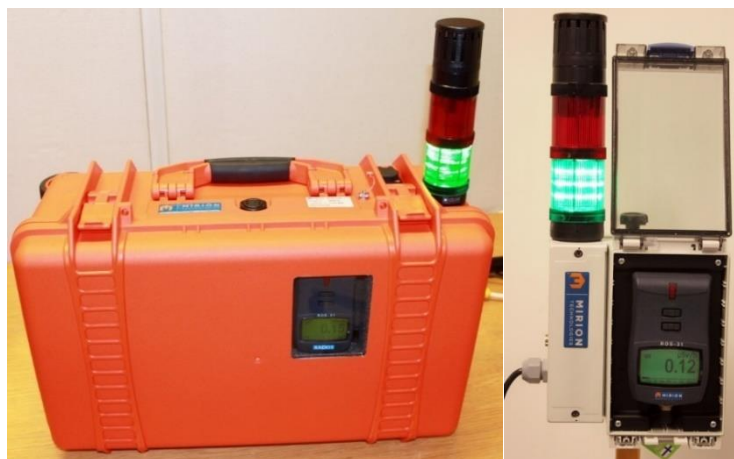
Kuva 32. RDS-31 –pohjaisia valvontalaitemalleja (Kuvat: Tuomo Saarinen).
