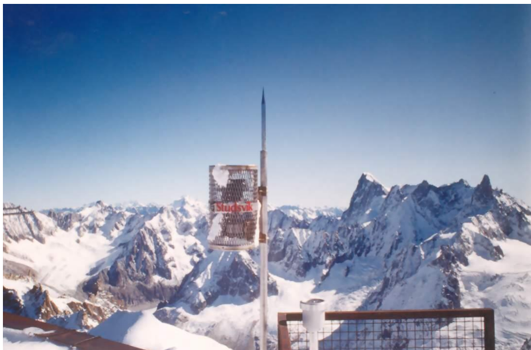
Kuva 17. RD-02 –ilmais-in sääsuojassaan SCRPI:n ukkossuojan sisällä Aguille du Midin näköalatasanteen reunalla, kyseessä ei siis ole roskakori. Korissa lukee Studsvik, koska Ranskan paikallisedustaja oli heidän agenttinsa. (Kuva: Mirion Technologies (RADOS) Oy).
