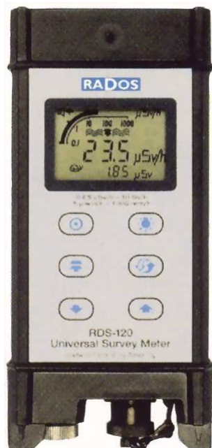
Kuva 18. RDS-120 Säteilyn yleismittari. Kuvassa oleva yksilö kantaa Rados-logoa, mutta ensimmäiset sarjat tehtiin jo vuonna 1992, jolloin yritys oli vielä Alnor Oy (Kuva: Mirion Technologies (RADOS) Oy).
