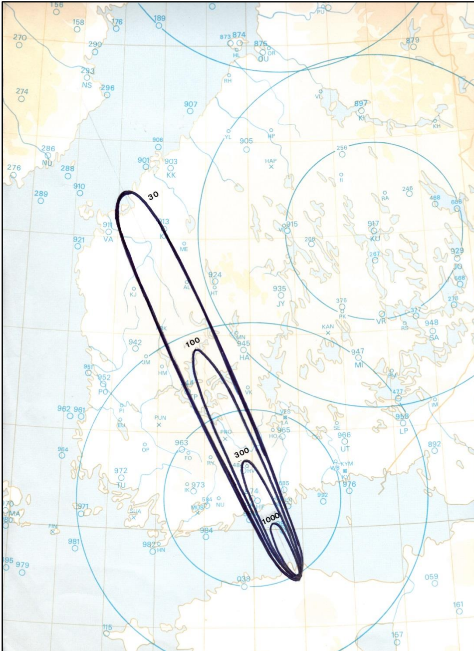
Kuva 3: Sikarimenetelmällä arvioitu akuutti säteilyannos 100 kt ydinräjähdyksestä Virossa (rads/4 vrk).
