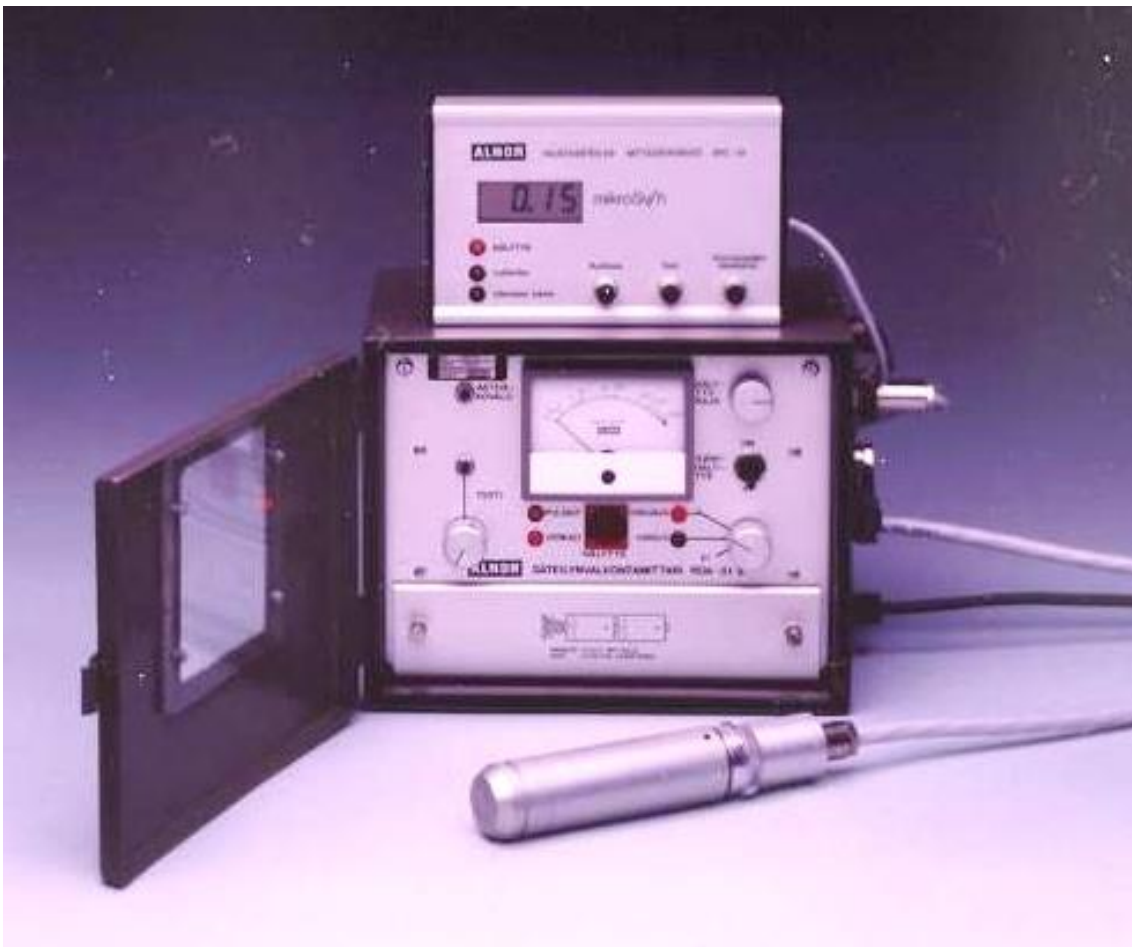
Kuva 12. RDS-31 –mittari ja APC-31 taustanäyttöyksikkö (Kuva: Mirion Technologies (RADOS) Oy).
