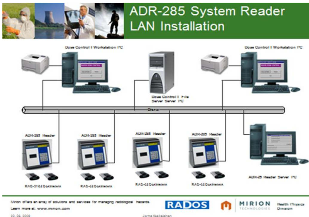
Kuva 27. Täysimittainen ADR-työdosimetrijärjestelmä (Kuva: Mirion Technologies (RADOS) Oy).
