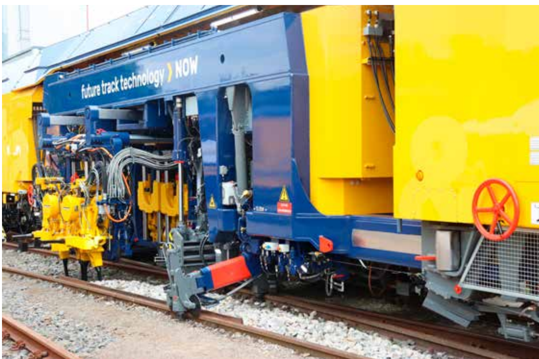
Ratatyökonemarkkinoilla on jo tarjolla täyssähköisiä raskaitakin työkoneita. Ajolangan alla virta otetaan virroittimella ratajohdosta.
