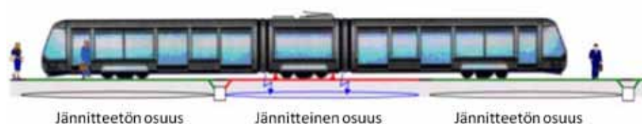
Yläkuvassa erotusjakso ja kytkentäyksikkö. Alakuvassa Bordeaux-periaate.
