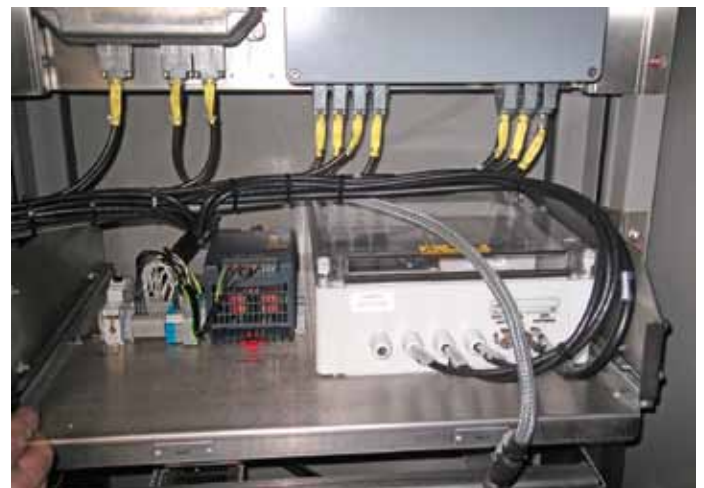
Sr2-veturiin asennettu energiamittausjärjestelmä. Kuva Ville Saarinen
