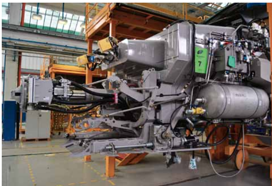
Puolaan rakenteilla olevan ETR610-tyyppisen junan keula kokoonpanovaiheessa
