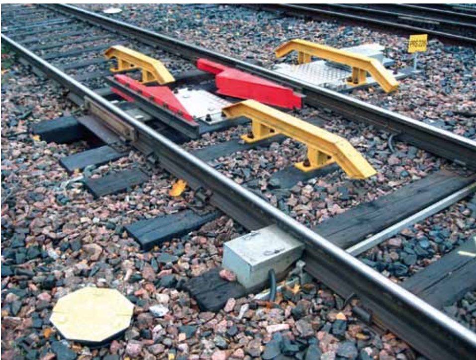
Kuva 4. Helsingin pysäytyslaite ja sen ohjauspaneeli Pasilan liikenteenohjauskeskuksessa. Kuvat Jukka Saha ja Esko Kajjansinkko.
