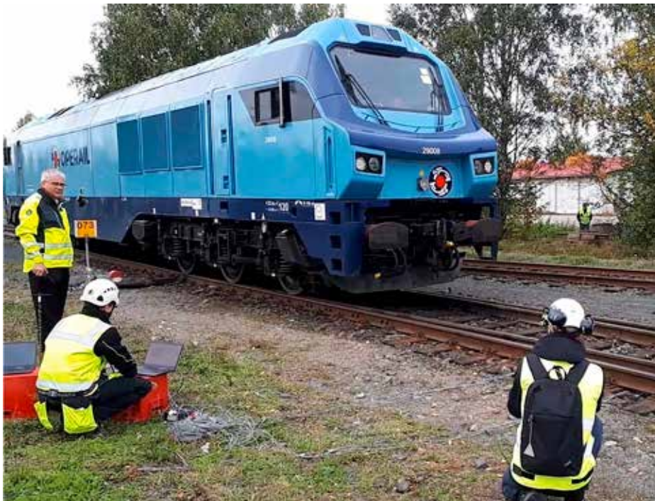
Kuva 3. Dr20 veturin testit ilman raidelevitystä olevassa R=200 vaihteessa Toijalassa. Kuva Heikki Luomala.
