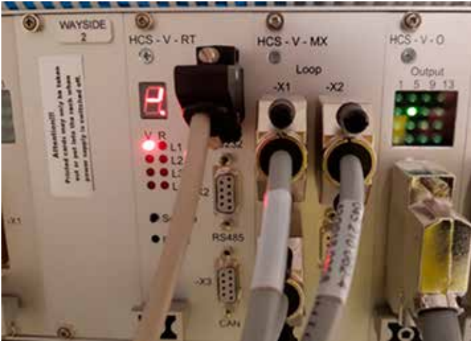
Kuva 3. Hanning&Kahl wayside-laite rajapintana asetinlaite-tytimeen
